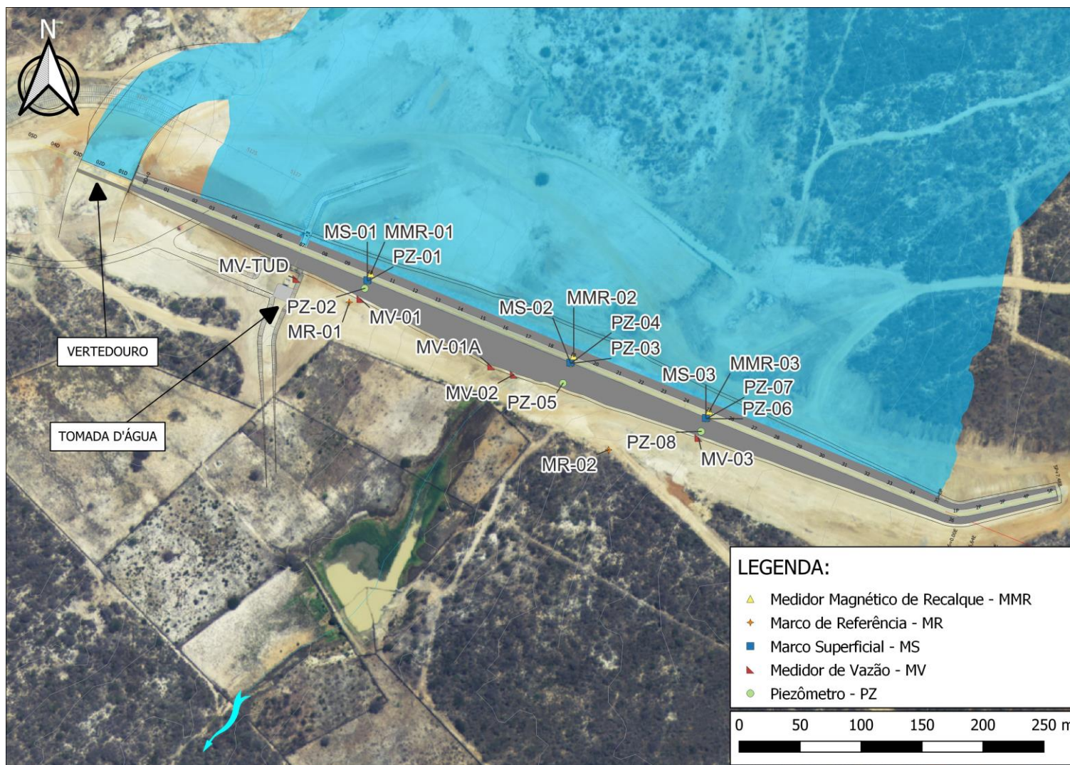
Figura 7.1 – Planta de localização da Instrumentação da Barragem Bagres. Fonte: Projeto Executivo n.º 1230-DEP-2110-20-04-001-R04 modificado/Google Satélite DATUM SAD 69.
